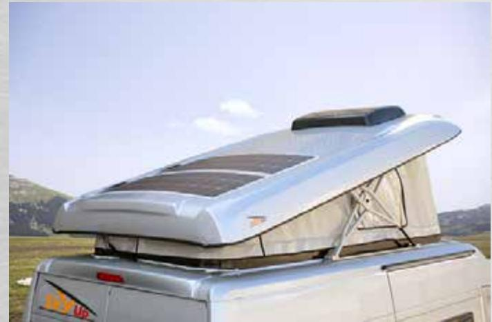
**TENDA INVERNALE:** Coibentazione ai massimi livelli ottenuta tramite l'impiego di uno speciale materiale utilizzato per la prima volta nel settore dei veicoli ricreativi. Grazie al sistema di cerniere zip, si sostituisce con estrema facilità alla tenda standard.
